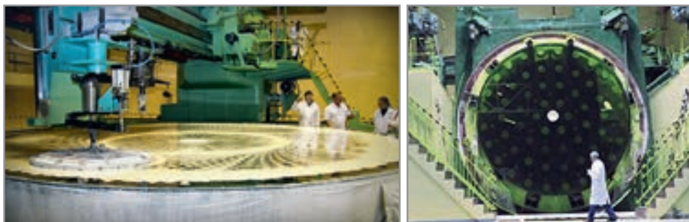
Рис. 11. Процесс полировки зеркала БТА диаметром 6 метров на станке КУ-168АДМ (ЛЗОС).
