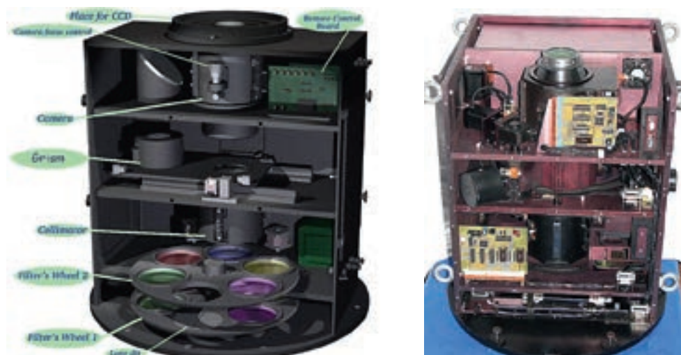
Рис. 20. Многорежимный фокальный редуктор первичного фокуса SCORPIO (слева) и универсальный спектрограф в первичном фокусе SCORPIO-2 (справа).
