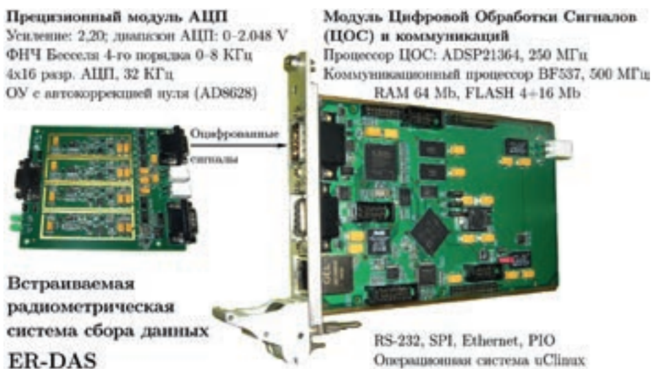
Рис. 31. Встраиваемая систем сбора данных и управления радиометров континуума.
