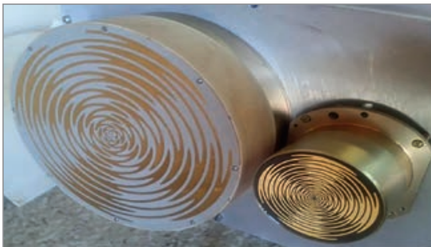
Рис 152. Входные облучатели солнечного приемного комплекса для перекрытия диапазона частот 0.75–18.2 ГГц (слева). Справа приведены облучатели волноводного типа для частот 6.7, 17.6 и 37.5 ГГц.
