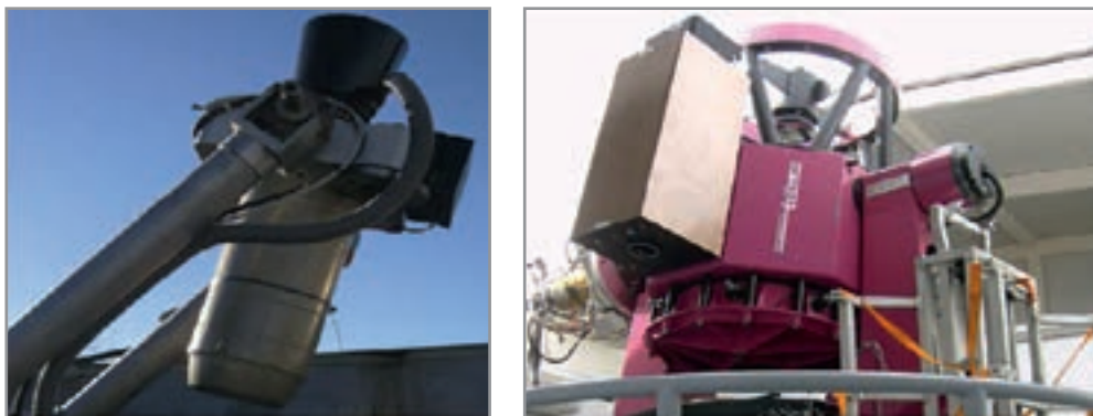
Рис. 103. Слева – быстрая широкопольная камера-прототип FAVOR (станция НИИ ПП, САО РАН); справа – камеры TORTORA, установленной на автоматическом телескопе REM (обсерватория Ла-Силла, ESO, Чили).
