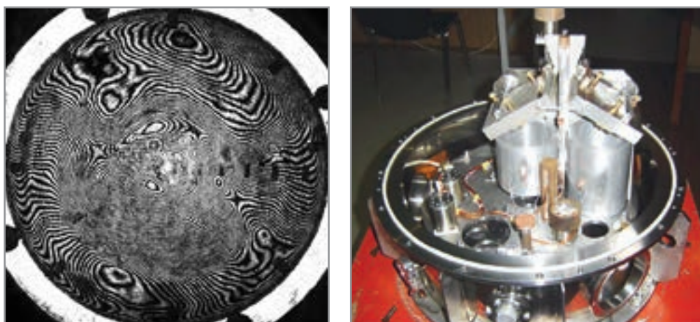
Рис. 13. Слева – интерферограмма ГЗ БТА, полученная в цехе ЛЗОС при доводке рабочей поверхности заготовки. Среднеквадратичное отклонение поверхности составляет 7\lambda , размах отклонений – 47\lambda . Справа – криостатированный спектрофотометр ИК-диапазона.
