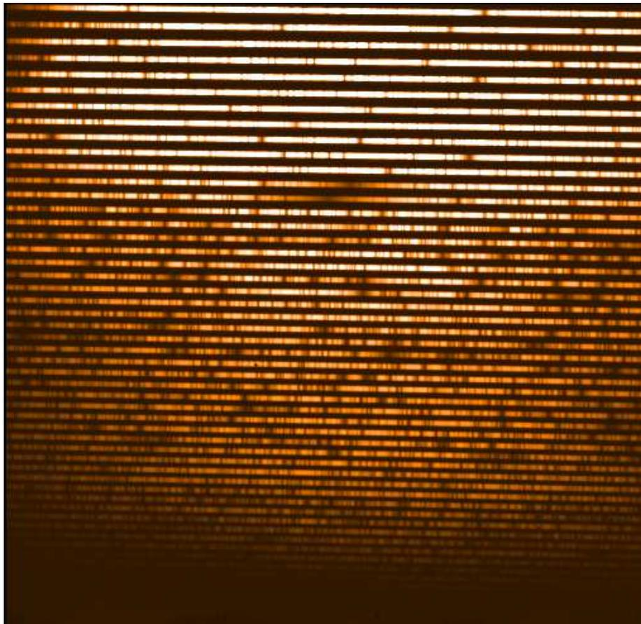
**Рис. 2.** Эшелле-спектр звезды спектрального класса G. Формат матрицы ПЗС 2048 × 2048 элементов, диапазон длин волн 2950–4450 Å. В средней части и выше центра кадра видны широкие абсорбции однократно ионизованного кальция (H Ca II  $\lambda = 3968.5$  Å и K Ca II  $\lambda = 3933.7$  Å). Высота каждого спектрального порядка определяется качеством изображения звезды и качеством гидирования.
