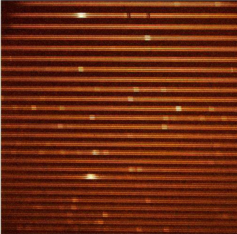
**Рис. 1.** Эшелле-спектр объекта CI Cam, полученный на НЭС БТА с резателем изображения (ширина среза  $0''4$ ). Формат матрицы ПЗС  $2048 \times 2048$  элементов, диапазон длин волн  $4500\text{--}6000 \text{ \AA}$ . Яркие детали: в верхней части кадра эмиссионная линия He I  $\lambda = 5875.6 \text{ \AA}$ , в нижней — эмиссия H $\beta$  бальмеровской серии водорода,  $\lambda = 4861.3 \text{ \AA}$ . П-образная форма эмиссий интерпретирована Miroshnichenko et al. (2002).
