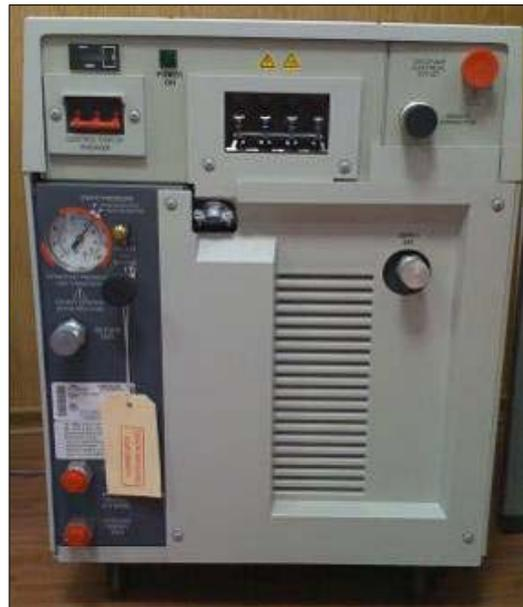
Рис. 10. Криогенный насос СТИ ISO520 (слева) с компрессором 8600 (справа) производительностью 10000 л/с по азоту.
