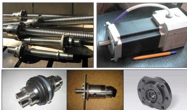
Рис. 51. Устройства, которые устранили люфты и повысить в десятки раз точность установки отражательных элементов радиотелескопа. Вверху: слева-винты на шариковинтовой передаче с гайками, справа - цифровой шаговый серводвигатель; внизу: слева-направо - безлюфтовой ЦРВС, подшипниковая опора, соединительное устройство.
