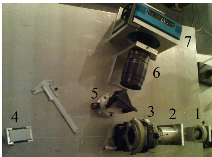
Рисунок 16 - Макет эшелле-спектрографа с интерферометром на внутренней установке, в котором сканирование спектра осуществляется путем изменения наклона ИФП к оси коллимированного пучка. Обозначения: 1 - оптоволоконный вход, 2 - линзовый коллиматор, 3 - интерферометр, 4 - решетка эшелле, 5 - призма скрещенной дисперсии, 6 – линзовая камера, 7 – светоприемник
