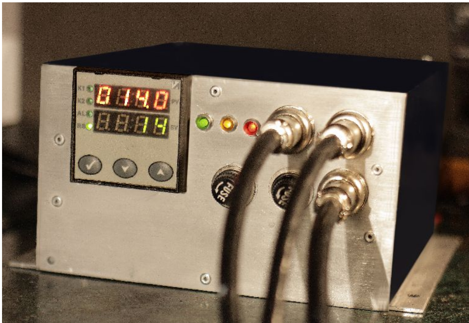
Высокоточный блок питания и регулятор температуры на микроконтроллерах для 3 мм радиометра
